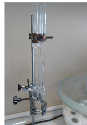
شکل ۲: ویسکومتر جهت تعیین ویسکوزیته
