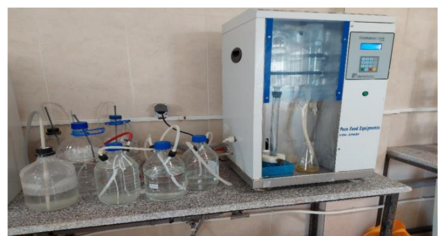
شکل ۳: اندازه‌گیری میزان نیتروژن علوفه مصرفی با روش کجدالال
